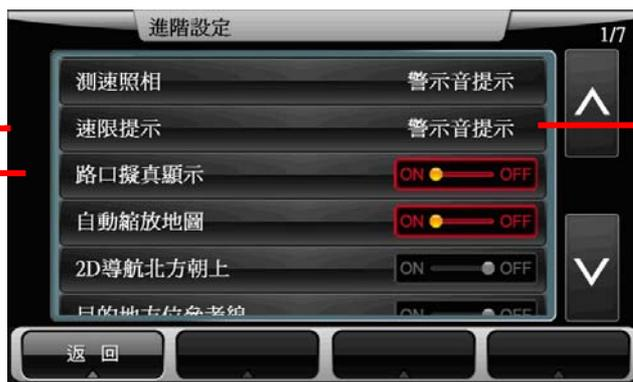
《速限提示》設定車速超過道路速限時的提示方式。
