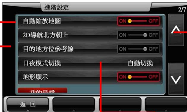
《2D 導航北方朝上》設定2D導航時車頭朝上或以北方朝上的方式呈現地圖畫面，請見【基本操作的 2.2】。
