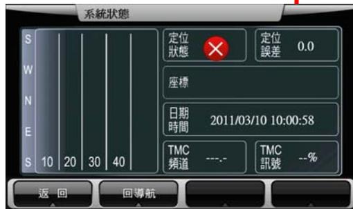
《顯示 GPS 及系統狀態》可用來查看 GPS 的定位狀態、座標、GPS 時間和電量等。
